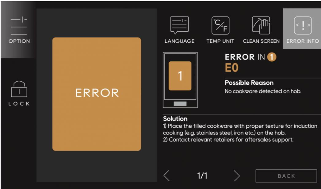
En cas d'erreur détectée, vous pouvez appuyer sur le bouton inférieur droit pour vérifier les détails.
